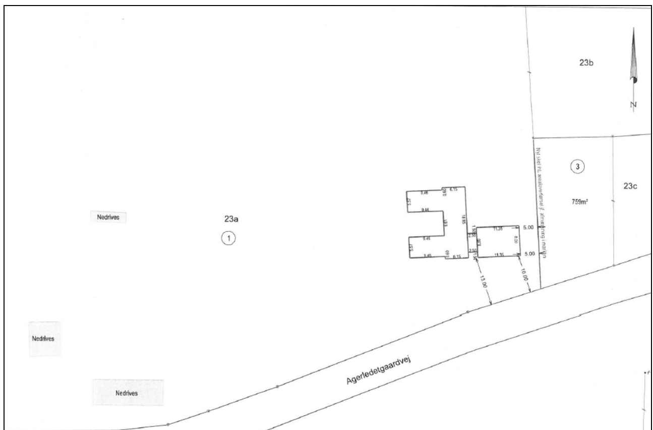
Situationsplan med angivelse af bygninger der neddrives samt placering af ny bebyggelse
