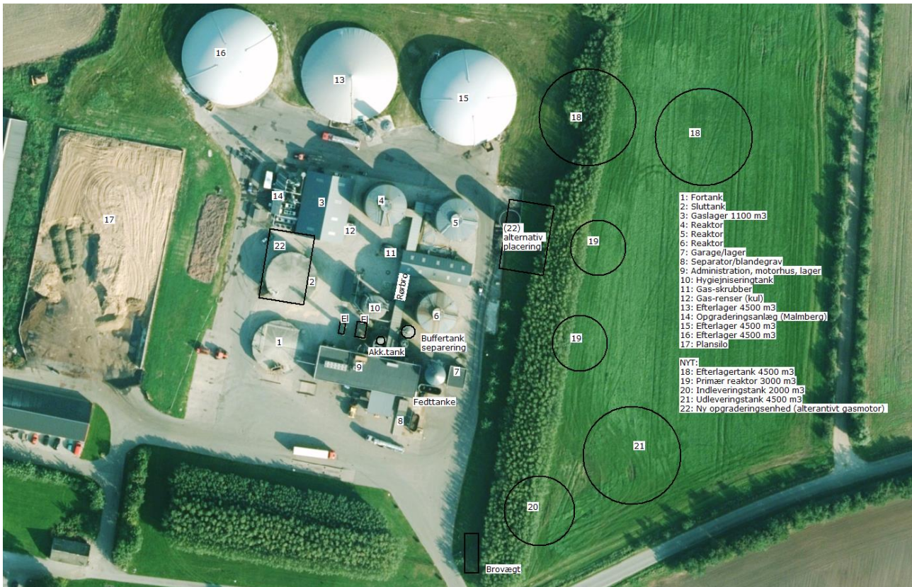
Figur 1: Anlægstegning, LBT-agro visende nye tanke til udvidelsen.
